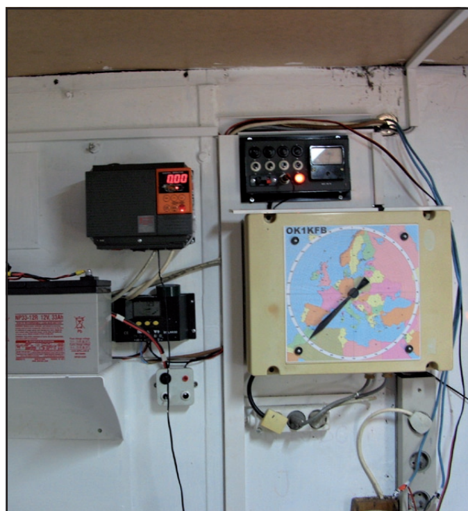
Ilustrační foto z provozu v objektu radiovozu na Haniperku v roce 2020. Na snímku vlevo dole inovovaný ukazatel nasměrování soustavy antén (práce Jirky OK1VTJ).
